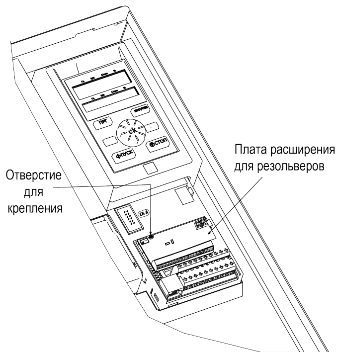
Рисунок 4.1 – Монтаж платы расширения для резольверов
