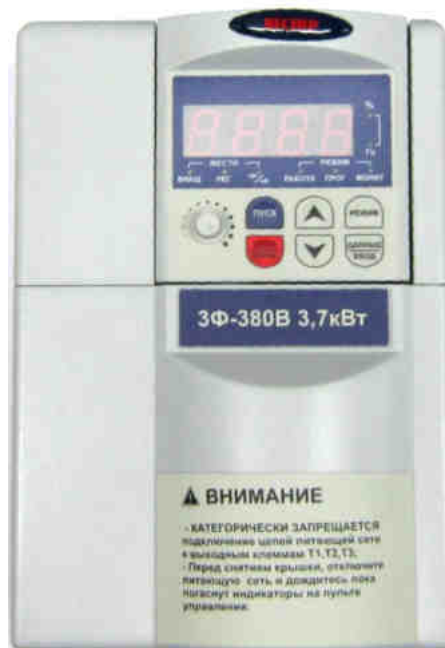
Рис. 4.1 Фото общего вида преобразователей ЕЗ-9100-003Н и ЕЗ-9100-005Н
