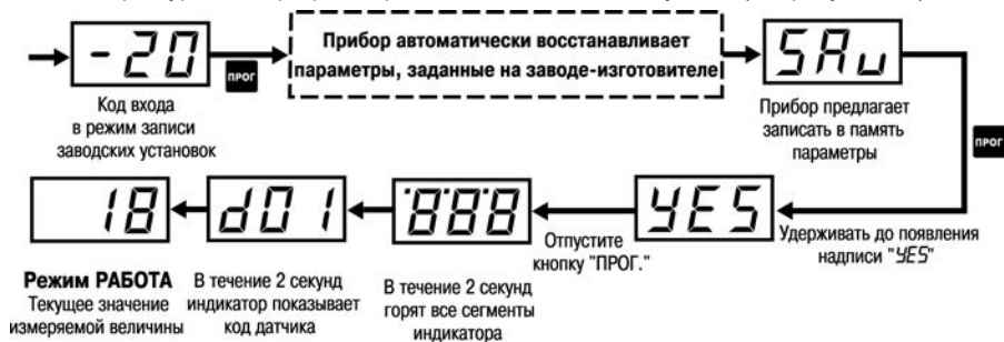
Рисунок 4.2 – Схема действий при восстановлении заводских установок
