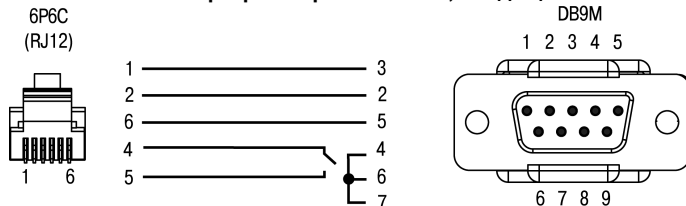
Рисунок В.2 - Схема кабеля KC3 для подключения модема к ПЛК150 по интерфейсу RS-232 Debug
